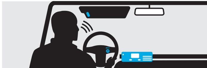
**Les chauffeurs** utilisent leurs radios mobiles XPR 5550e pour confirmer qu'ils sont en route. Le micro de pare-soleil et le bouton de transmission montés sur le volant leur permettent de communiquer en toute sécurité sans qu'ils aient à quitter la route des yeux.
